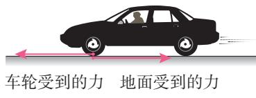
图 3.3-5 汽车受驱动力的示意图
