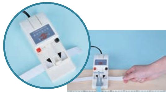
图 1.2-8 使用电火花打点计时器
