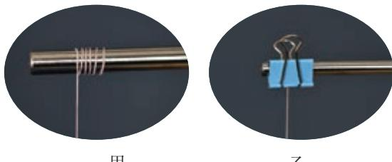
图 2.5-2 细线上端的两种悬挂方式
