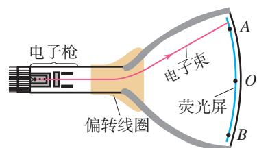
图 1.2-7 显像管原理示意图
