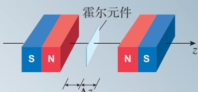
图 5.2-13 利用霍尔元件测量微小位移
