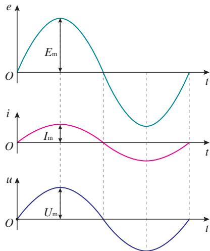
图 3.1-6 正弦交变电流随时间的变化
