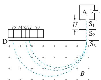
图 1.4-1 质谱仪工作原理
