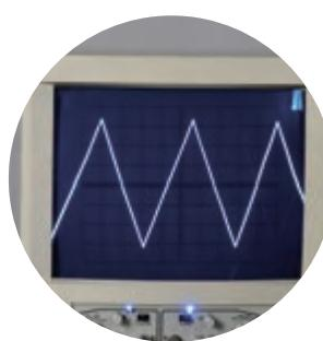
乙 示波器中的锯齿形扫描电压
