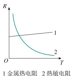
图5.2-4 电阻随温度的变化关系
