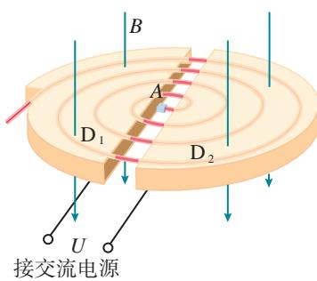
图 1.4-3 回旋加速器的原理
