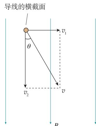
图 2.2-3 导线运动方向不与磁感线垂直时的情况
