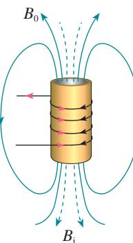
图 2.4-2 感应电动势阻碍电流的增加
