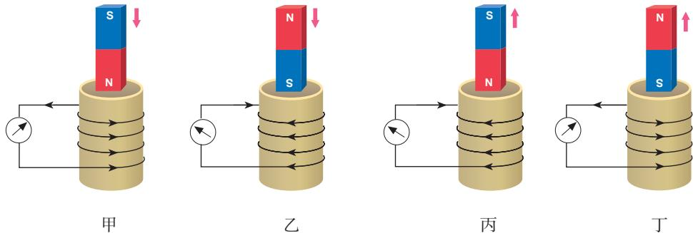
图 2.1-1 研究感应电流方向的实验记录
