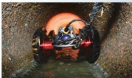
机器人在下水道里探测水下管网
