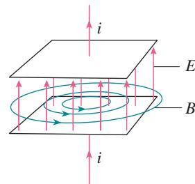
图4.2-2 变化的电场产生磁场
