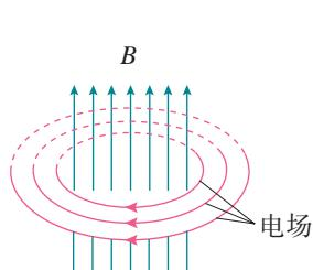
图4.2-1 变化的磁场产生电场
