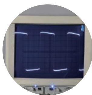
丙 电子电路中的矩形脉冲
