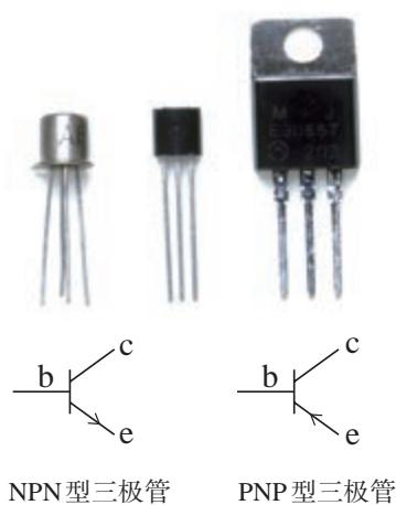
图5.3-4 三极管电路符号及实物图
