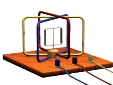
图 2.3-11 产生旋转磁场的装置
