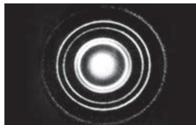
图 4.5-1 电子束穿过铝箔后的衍射图样
