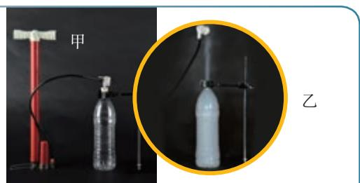
图 3.1-4 观察橡胶塞跳出时瓶内的变化
