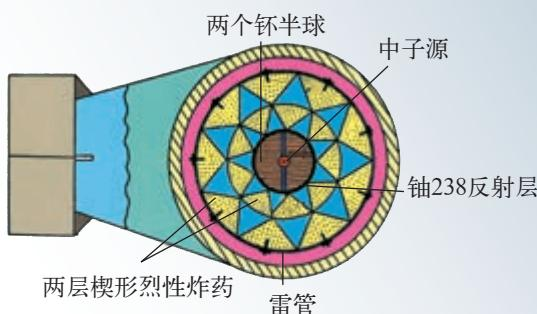
图 5.4-3 内爆式原子弹示意图
