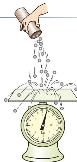
图 1.3-4 模拟气体压强产生机理的实验
