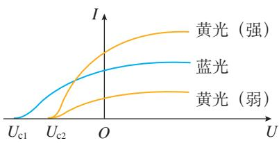
图 4.2-2 光电流与电压的关系
