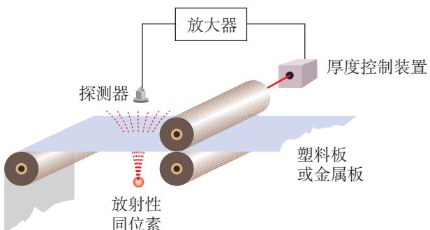
图 5.2-5 射线测厚装置
