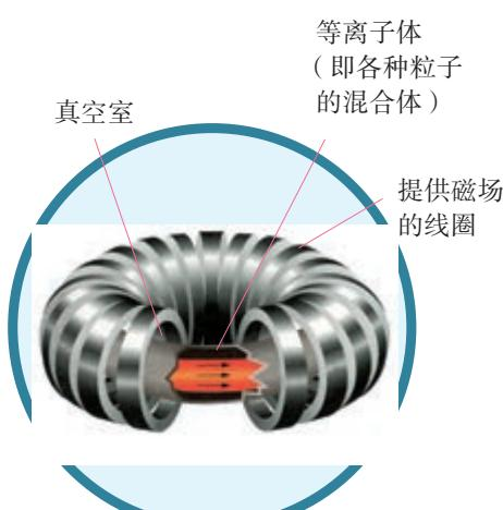
图 5.4-9 环流器的结构示意图
