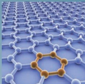
图 2.4-12 石墨烯六边形的晶格结构
