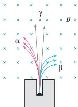
图 5.1-1 三种射线在磁场中的运动径迹不同
