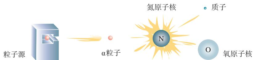
图 5.1-4  $\alpha$ 粒子轰击氮原子核示意图
