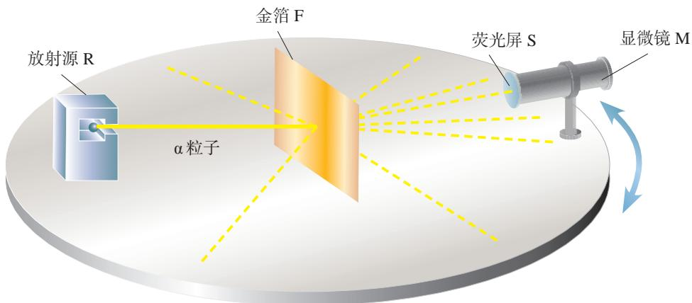
图 4.3-3  $\alpha$  粒子散射的实验装置示意图
