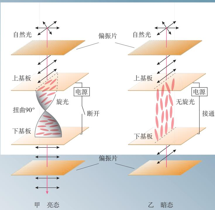
图 2.5-10 TN 模式液晶显示器的基本工作原理示意图
