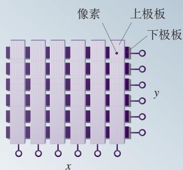
图 2.5-11 像素矩阵显示中的条形电极
